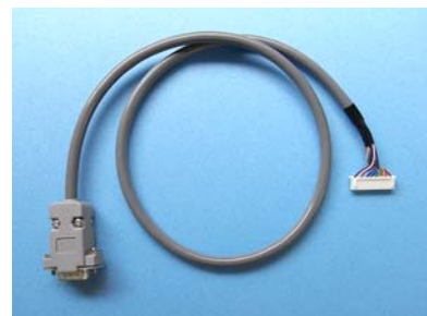
付属ケーブル (Revolution-GPIO I/F 基板間)
